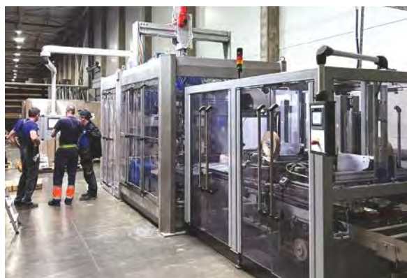
Първата промишлена инсталация на палетна система ixs-pal ® в голям хартиен завод
